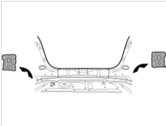
3. 钻穿所有连接后部板的点焊位置。
