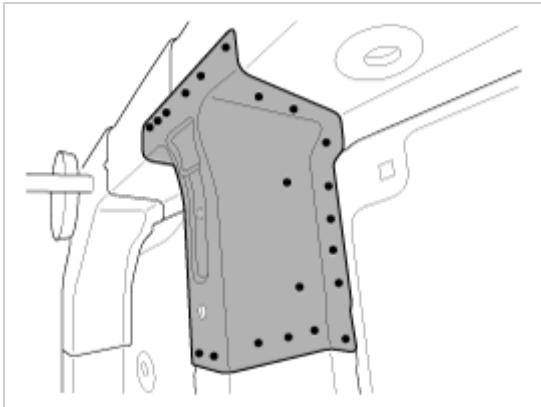
9. 沿新后围板边缘钻孔以便进行MIG填焊。
