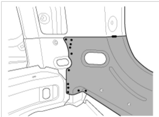
13. 沿新后部板边缘钻孔，以便进行MIG填焊。
