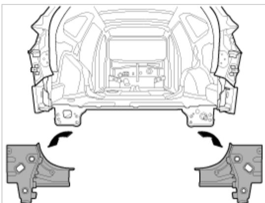
7. 要拆卸后底板侧后梁，钻穿所有连接后底板横梁延伸的点焊位置。
