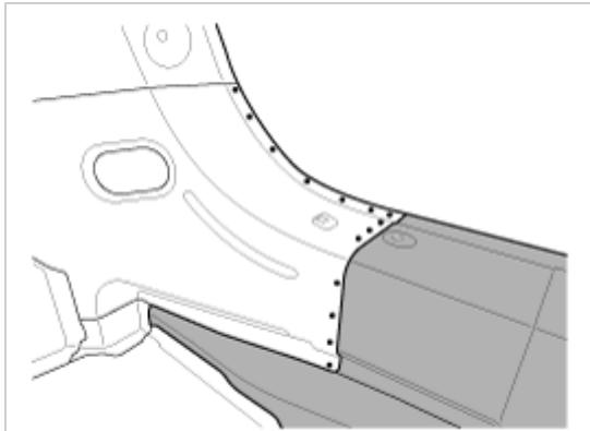
17. 沿新后底板加强件的边缘钻孔，以便进行MIG填焊。
