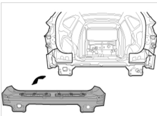
5. 钻穿所有点焊位置，研磨附着后围板的MIG搭接焊位置。
