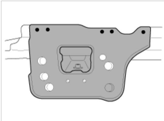
5. 沿新后底板侧横梁延伸的边缘钻孔，以便进行MIG填焊。
